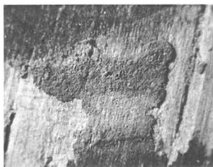
▲図26 顕微鏡撮影箇所B(×39倍) 青系の粒子があるのが確認できた。
